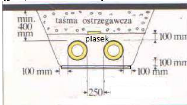
Rys. 4.1. – Ułożenie rurociągów
